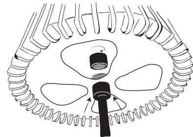
6. Entfernen Sie den Ring vom Lampenfuß, setzen Sie dann den Lampenfuß D in den mittleren Kreis des Teils B ein und ziehen Sie den Ring fest.
