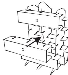
3. Nehmen Sie die stehenden Teile B&C und befestigen Sie diese an einem der Querträger A. Schieben Sie nun die hinteren zwei Querträger wie abgebildet in die Hochformateile.
