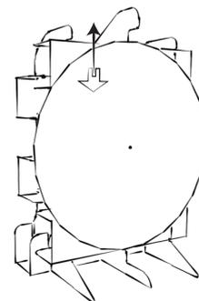
5. Fügen Sie nun die rotierende Platte D hinzu, indem Sie diese mithilfe der Kappe im Loch des mittleren Querträger befestigen.
